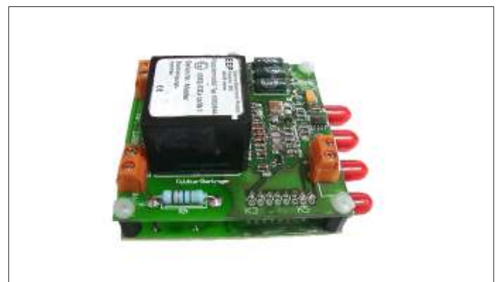
Eigensicheres Profibus-Modem für RS485, RS232, BB 22444, LWL etc.
