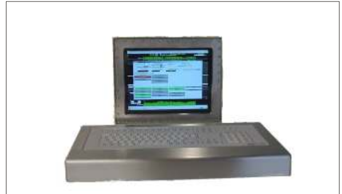
Industrie PC PR111 für Chemie und Bergbau zur Visualisierung und Steuerung von Betriebsmitteln (PROFIBUS- Technologie)
